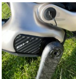
Der Motor ist mit 2,1 kg ein Leichtgewicht und bereits in der 2. Generation von BH hergestellt.
